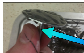
BEDEK HET DRAAD MET TAPE OM TE VOORKOMEN DAT DAAR EPOXY OF TERECHT KOMT
